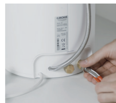
Sluit de boiler aan op de veiligheidsgroep en kraan. Open daarna de hoekstopkranen voordat je de stroom aansluit.
